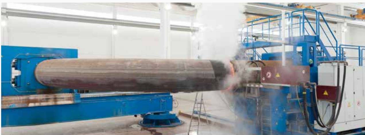
Новый электрический трубогибный станок с индукционным нагревом Schäfer SRBMI 1400
