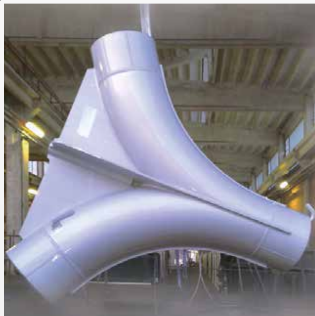
Специальный Y-образный тройник из нержавеющей стали. Механическое устройство с разработанной компанией SAIPEM технологией
